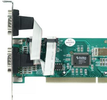
Die LCS-6021 ist eine Multi I/O Kontroller Karte für den PCI-Slot. Heutzutage kommen mehr und mehr Mainboards ohne serielle und parallele Ports auf den Markt, der LCS-6021 ist die Lösung und gibt Ihnen die fehlenden Ports zurück. Der Adapter ermöglicht das Anschliessen von Druckern, Maschinensteuerung oder anderen Geräte.
