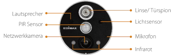
Kamera : Einheit für Außenseite Tür
