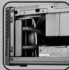
Unterstützt 120/140-mm-Lüfter und Alles-in-Einem-Wasserkühler
