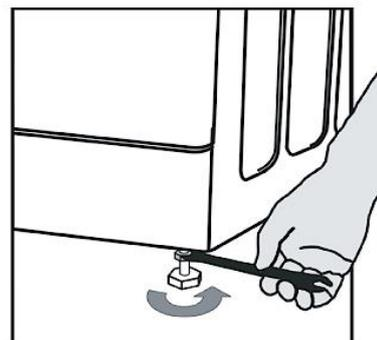
c. Bitte beachten Sie: Der Abstand zwischen Kontermutter und verstellbarem Fuß darf maximal 20 mm (2,00 cm) betragen!
