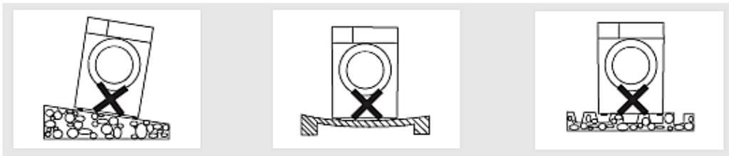
11. Falls Sie das Gerät auf einem Holzfußboden installieren, **müssen** Sie es zusätzlich auf eine **mindestens** 3,00 cm dicke Sperrholzplatte (60,00\*60,00 cm) stellen, um das Gewicht des Gerätes zu verteilen. Befestigen und sichern Sie die Sperrholzplatte ordnungsgemäß auf dem Holzfußboden.
