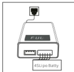
Sobald der Akku vollgeladen ist, zeigt das Display „FUL“ an und blinkt abwechselnd mit der Akkuspannung.
