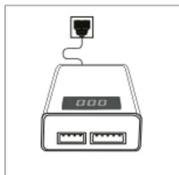
Schließen Sie das Netzkabel am Ladegerät und dann an der Steckdose an.
