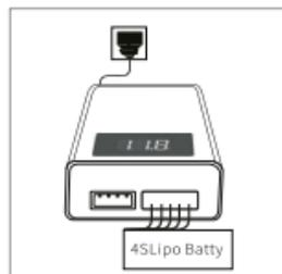
Schließen Sie den LiPo Akku mit dem Balance-Stecker an der entsprechenden Buchse an. Achten Sie darauf, dass der Stecker richtig herum ist. Die Gesamtspannung wird angezeigt.
