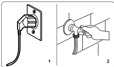
1. Schließen Sie Ihr Gerät an die Stromversorgung an.
