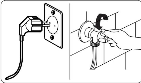
Schalten Sie Ihre Maschine aus und ziehen Sie den Netzstecker aus der Steckdose, bevor Sie Reinigungs- oder Reinigungsarbeiten an ihr vornehmen.
