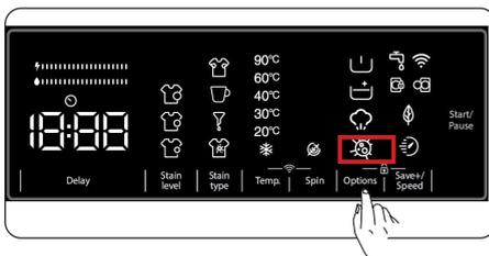
Mit dieser Zusatzfunktion können Sie einen weiteren Spülgang für Ihre Wäsche zufügen. Ihr Gerät nutzt in allen Spülschritten heißes Wasser. (Empfohlen für Kleidung, die mit empfindlicher Haut in Kontakt kommt, Babykleidung und Unterwäsche.) Aktivieren Sie die
