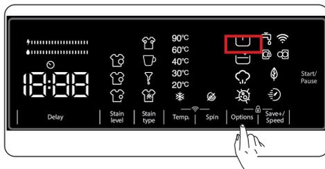
Mit dieser Zusatzfunktion können Sie bei stark verschmutzter Wäsche vor der Hauptwäsche eine Vorwäsche durchführen. Wenn Sie diese Funktion nutzen, müssen Sie Waschmittel in den Vorwäsche-Behälter der Waschmittelschublade geben. Aktivieren Sie die Vorwäsche-Zusatzfunktion, indem Sie die Optionstaste drücken, bis das Vorwäsche-Symbol ☞ aufleuchtet. Falls die Vorwäsche-LED ☞ dauerhaft auf der elektronischen Anzeige erscheint, bedeutet dies, dass die Zusatzfunktion ausgewählt ist.
